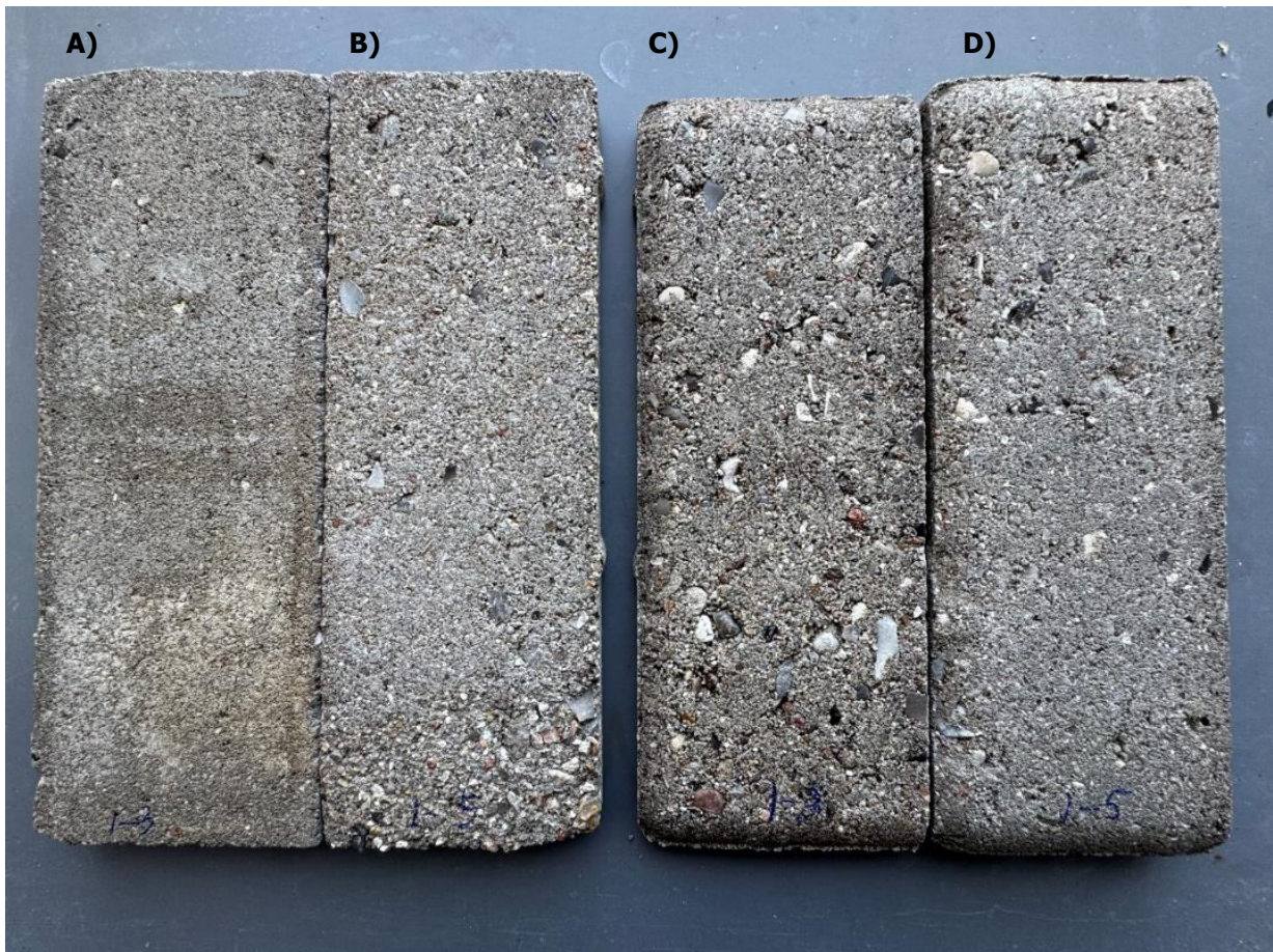
Foto 13 Test emner efter eksponering. A) Slidt flise med opløsning 1:3, B) Slidt flise med opløsning 1:5, C) Nyskåret flise med opløsning 1:3, D) Nyskåret med opløsning 1:5.
