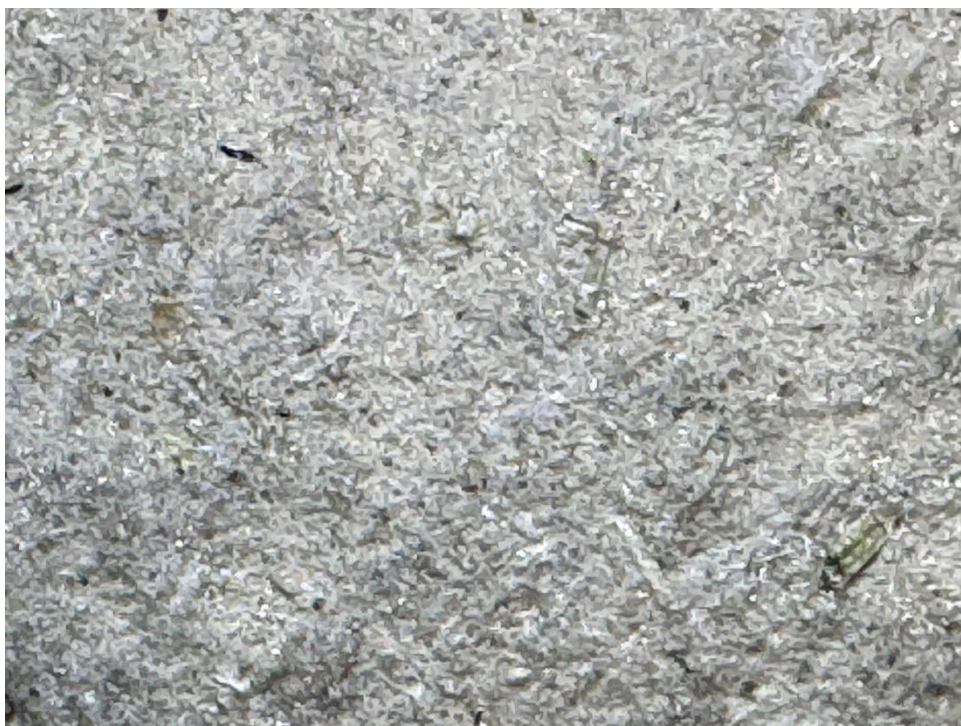
Foto 7 Test panel med opløsning 1:5. Næsten alt asbest forseglar er væk og resten sidder ikke fast til overfladen.
