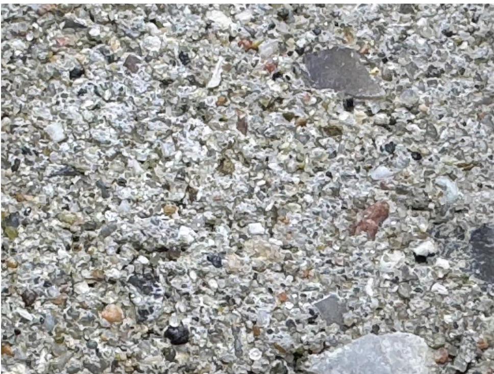
Foto 15 Nyskåret flise i opløsning 1:5. Laget med asbest forseglers tyndere end flisen påført opløsning 1:3, men dækker stadig hele overfladen.
