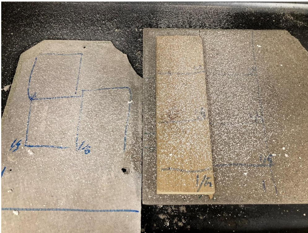
Foto 1 Plader med asbestfibre
