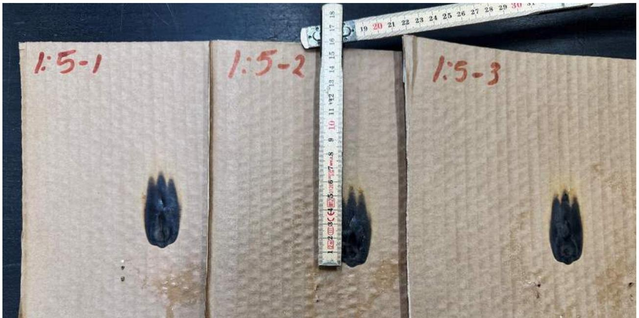
**Foto 3 Testplatten mit SPS Fiber Sealer Mischung 1:5**
