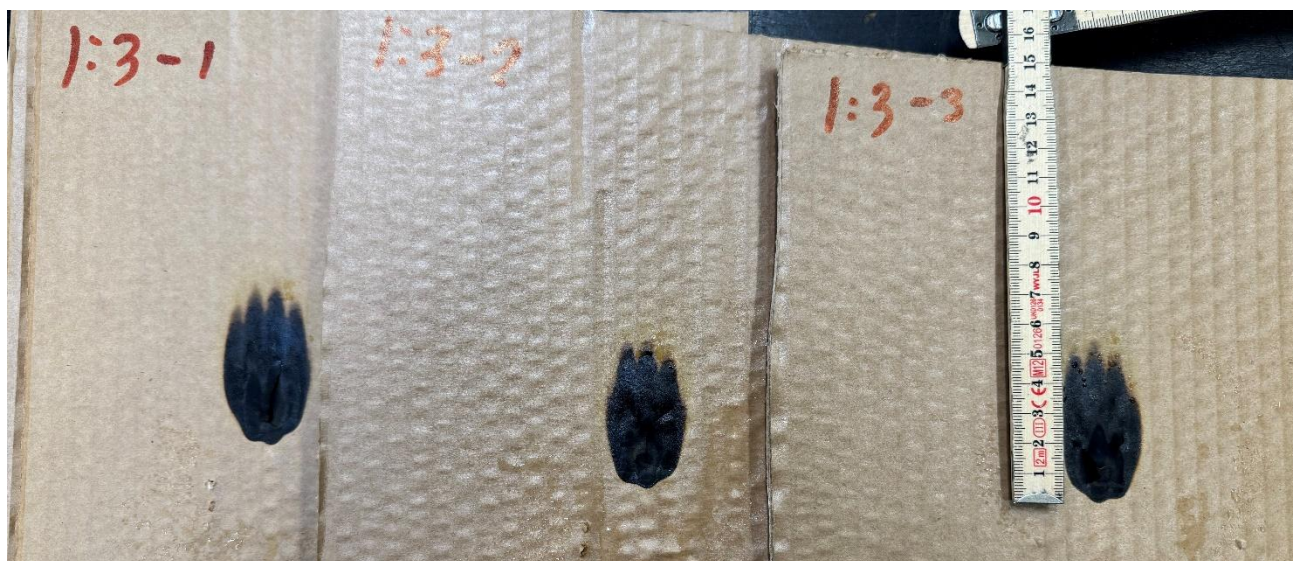
Foto 2 Testplader med SPS Fiberforsegler blanding 1:3
