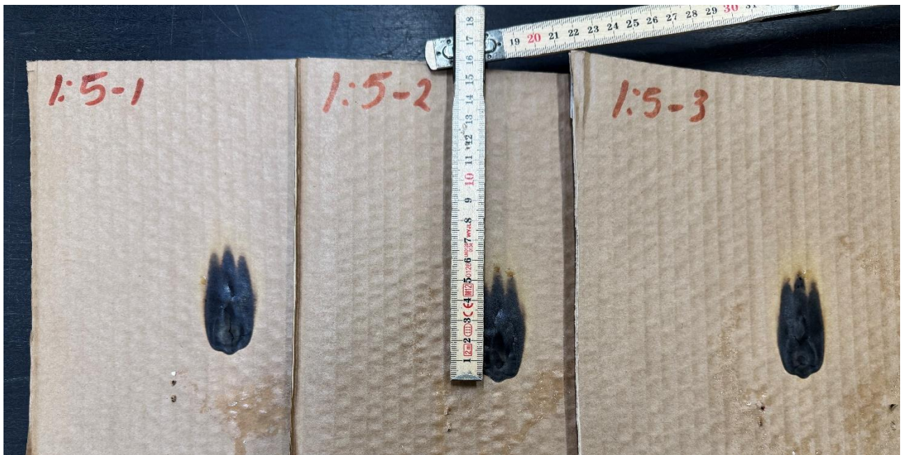
Foto 3 Testplader med SPS Fiberforsegler blanding 1:5
