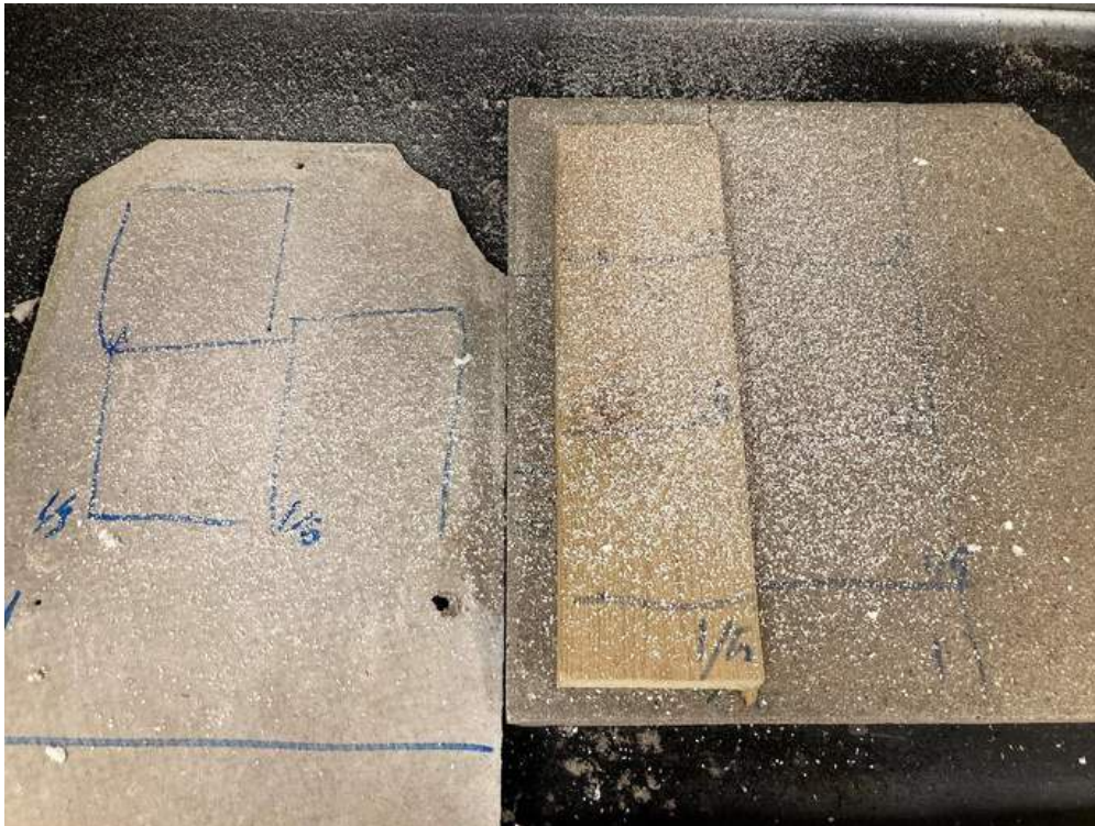
Foto 1 Platten mit Asbestfasern
