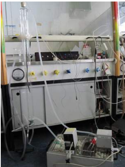
Abbildung 1 Thermostatisierte Säule mit Verbindungsstück
