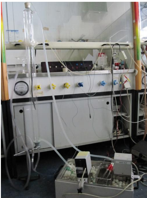
Figur 1 termostateret søjle med fuge
